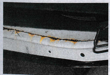
Die Stoßfänger beginnen in der Regel von der Innenseite durchzugammeln
