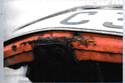
Enten-Hauptproblem ist der Rost. Hier blüht's an der Motorhauben-Unterseite
