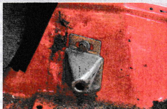
Hintere Radhäuser, die innen so aussehen, schreien nach Arbeit
