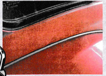
Am hinteren Kotflügelansatz versteckt sich oft übler Rost
