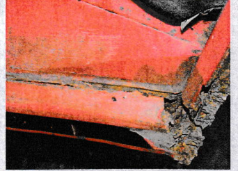
Ente sauer: Dieser C-Säulen/Kasten-Bereich hat es hinter sich
