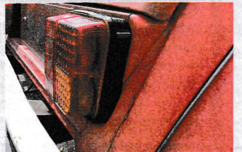
Das Blech neben und unter den Rückleuchten ist oft angefressen
